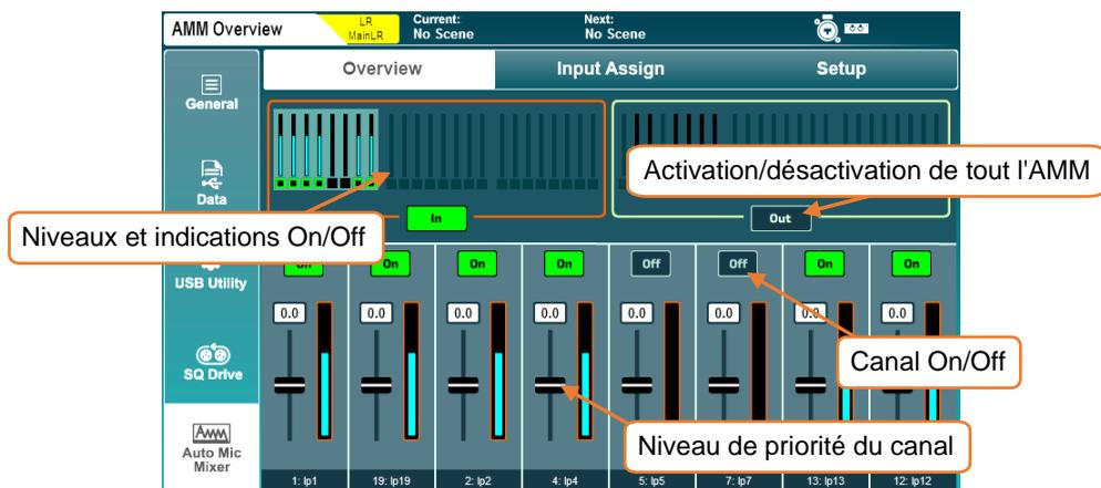
La partie haute de l'écran affiche tous les emplacements d'AMM, les indicateurs de niveau montrant le gain appliqué aux canaux et si l'AMM des canaux est ou non activé.
